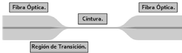
Fig. 1. Estructura de una fibra óptica adelgazada (“taper”).
