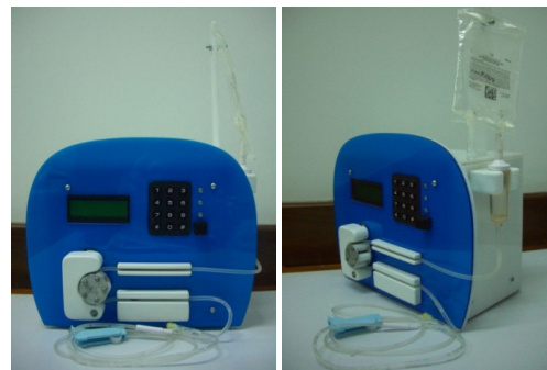
Fig. 6: Vistas del prototipo funcional de la bomba de infusión peristáltica circular.
